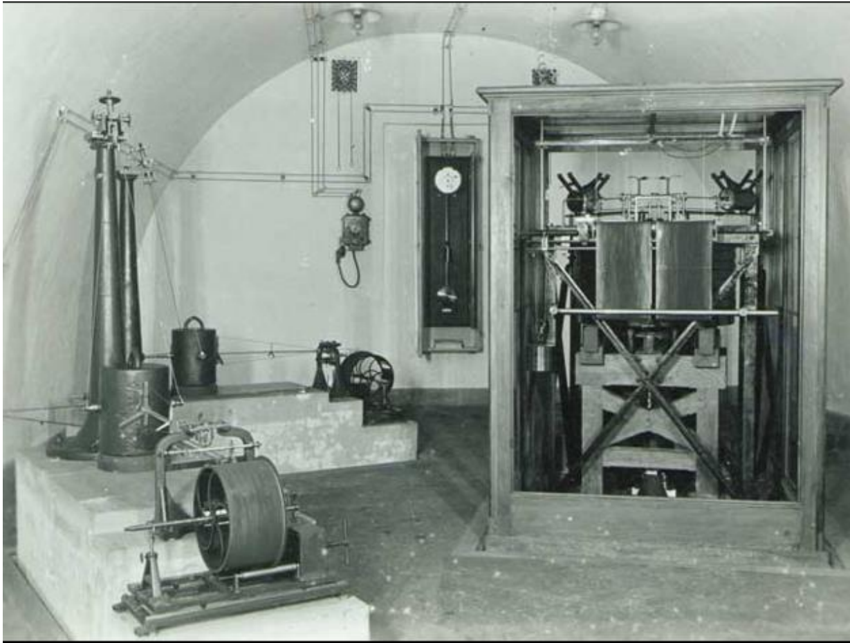
Seismometers in het ondergronds laboratorium in Ukkel (1909) Links: twee horizontale Bosch-Omori-seismometers, Rechts: de horizontale Wiechert-seismometer (1000 kg)
