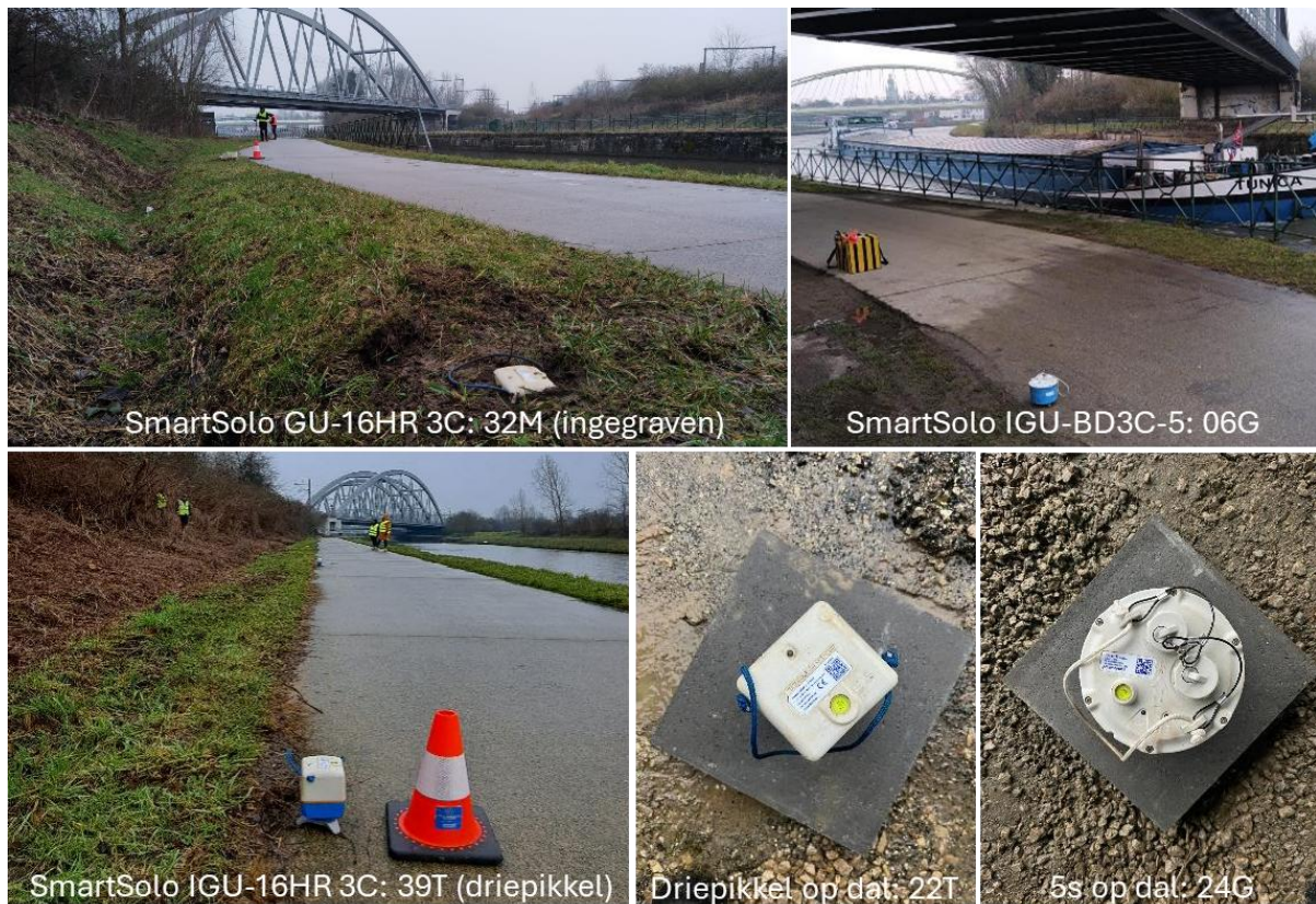
Figuur 5 : Overzicht van SmartSolo geofonen gebruikt in deze studie. Ronde blauwe toestellen zijn SmartSolo 5 s IGU-BD3C-5 geofonen. Vierkante toestellen zijn SmartSolo 5 Hz IGU-16HR 3C geofonen. Installatie van IGU-16HR 3C gebeurde ofwel door hen in te graven, ofwel door installatie op een metalen driepikkel op het jaagpad of op een stenen dal.
