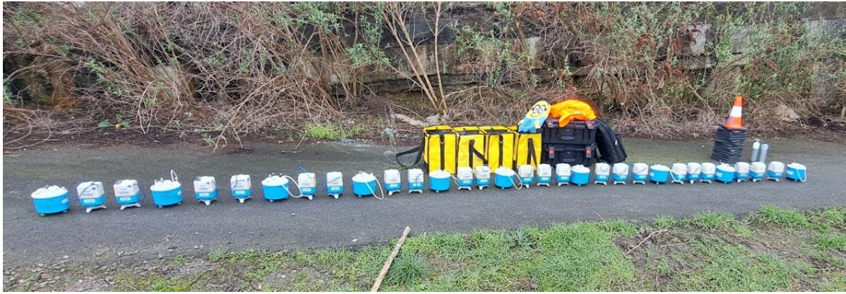
Figuur 5 : Overzicht van SmartSolo geofonen gebruikt in deze studie. Ronde blauwe toestellen zijn SmartSolo 5 s IGU-BD3C-5 geofonen. Vierkante toestellen zijn SmartSolo 5 Hz IGU-16HR 3C geofonen met lage capaciteitsbatterijen geïnstalleerd op een metalen driepikkel.
