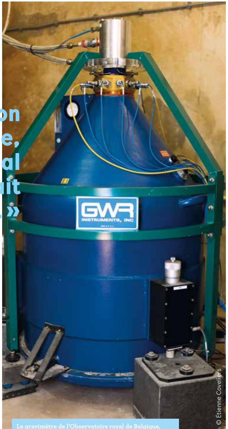
Le gravimètre de l'Observatoire royal de Belgique, à Membach.
