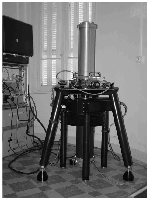
Figure 2. Le gravimètre absolu FG5-202 de l'O.R.B. en mesure à l'Observatoire de Nice (Photo J.-J. Walch)
